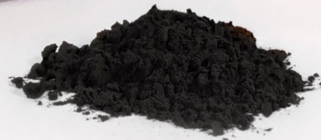
Ligniinistä jalostetusta kovahiilijauheesta valmistetaan elektrodiarkkeja ja -rullia, joita käytetään litiumioniakun valmistuksessa.
